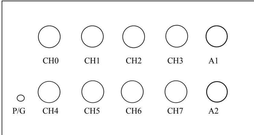
**前面板:** 8个模入插座, 电源/GPS 信号指示。2个备用插座 A1, A2。
